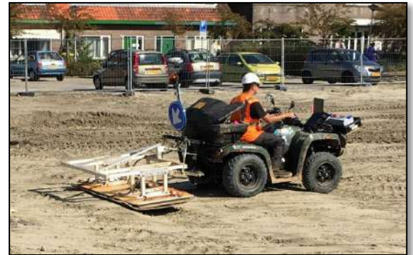
De 3D grondradar achter een quad
