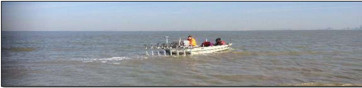
Uitvoeren passieve NON realtime waterbodemdetectie m.b.v. detectieboot.
