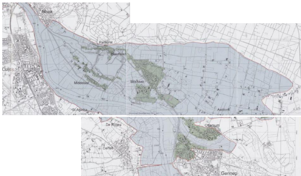
Figuur 3: Kaart bij Besluit rijksrivieren van 12 april 2001, met in lichtblauw het rivierbed met vergunningplicht, in lichtgroen het gebied waar geen vergunningplicht geldt en met rode lijn de hoog waterkerende gronden.
