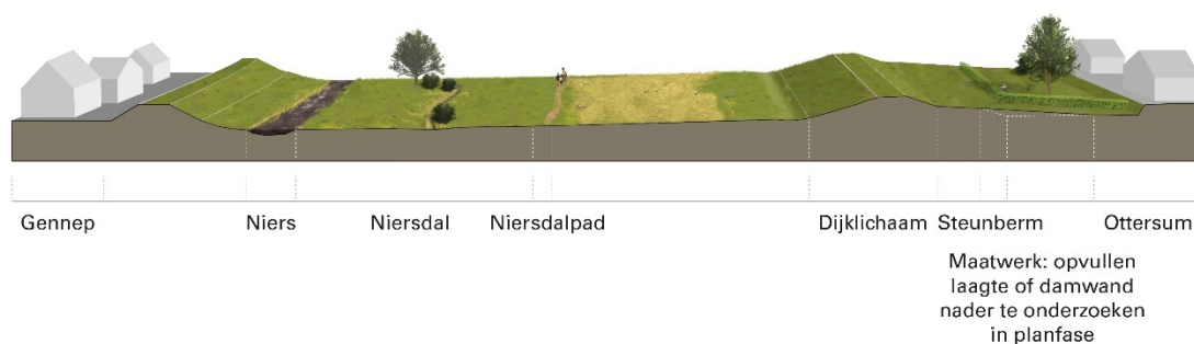
Afbeelding 26: Perspectiefdoorsnede dijkversterking deelgebied Niersdal
